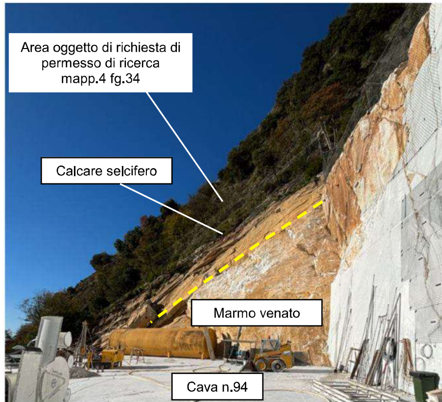
Foto 2 – panoramica del contatto stratigrafico tettonizzato tra marmi e calcari selciferi nei pressi delle nuove lavorazioni eseguite a quota circa 610 nella cava n.94 "Valbona B"
